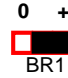
Fig.9 : Configuration de BR1 pour commande de FM et FD active à 0V (Configuration pour armoire ASP116)
