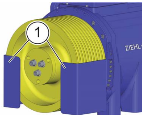
Figure 4-5-3-01 - Protection des câbles avec de poulie motrice 400 x 186
