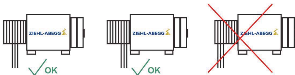
Figure 4-3-01 - Mise en place des câbles
