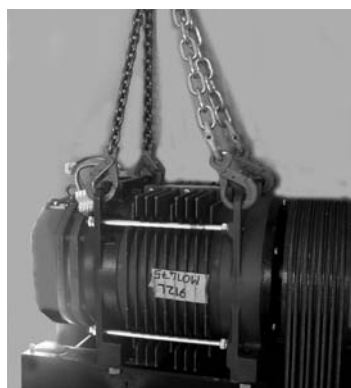
Figure. 1c Exemple de préhension pour la manutention du moteur G-400.
