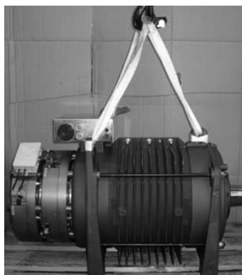
Figure. 1b Exemple de préhension pour la manutention du moteur G-500.
