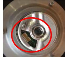
Le codeur de la machine Gearless possède un axe conique.
